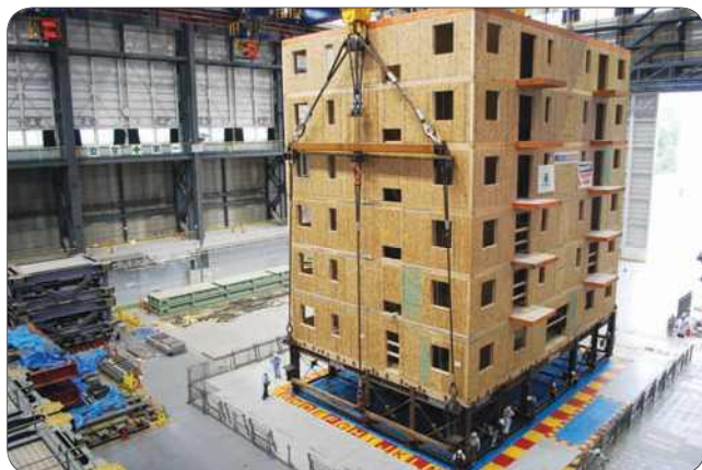
<그림 1> Woodframe Building Shake table test
